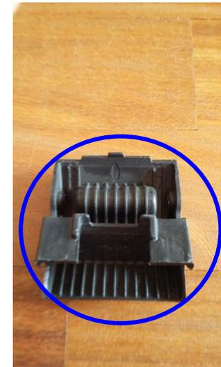
3. Mettre du **silicone** sur les **6 vis**. Ensuite remonter le cache en mettant de la **graisse épaisse (ou de bateau)** autour du cache et dans le **joint passe-fil** (vous pouvez aussi le faire avec du silicone à la place de la graisse)
