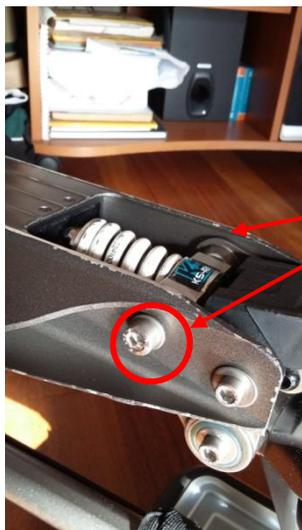
Vous pouvez, pour mettre le silicone sur le cache, et pour que ce soit plus facile, **dévisser les 2 vis** qui tiennent l'amortisseur et **faire basculer l'ensemble de la roue arrière** de façon à avoir le cache bien accessible
